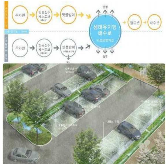
[그림52] 남해군 생태주차장(좌), 서울시 월드컵공원 빗물관리 주차장 시스템 개념도(우)
