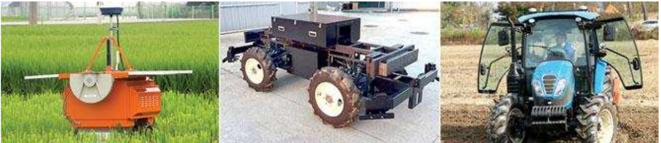
[그림1] 제초로봇 현장적용시험(좌, 중).LS엠트론 자율주행트랙터(우)
