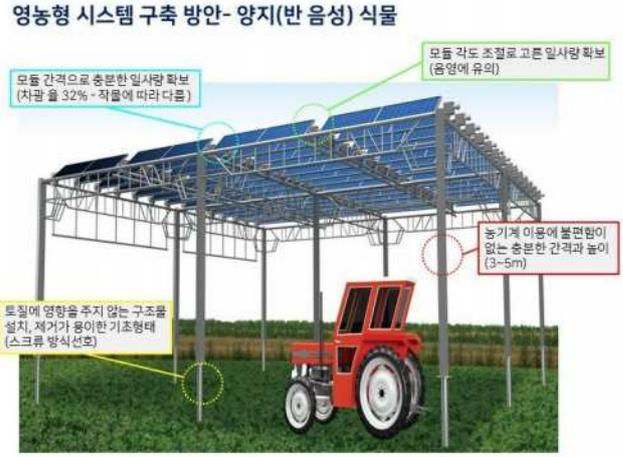
[그림110] 영농형 태양광 전경(좌) 및 영농형 태양광시스템 구축 방안(우)
