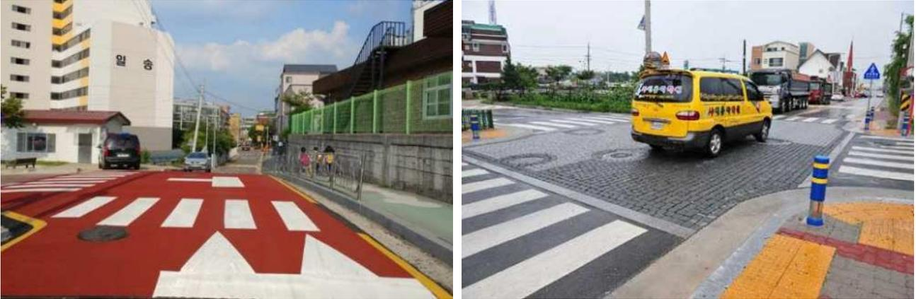
[그림49] 도로교통 안전시설인 고원식교차로 설치(좌) 및 속도저감 위한 도로포장(우)
